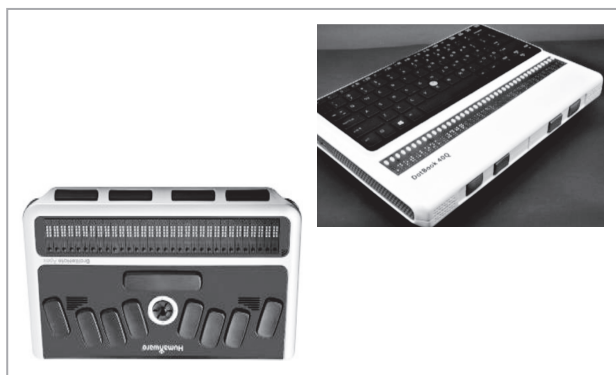
شکل ۸) دستگاه یادداشت‌بردار بریل یا برجسته‌نگار هوشمند همراه و نمایشگر بریل با قابلیت لپ‌تاپ
